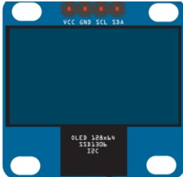
OLED-Displays (Organic Light Emitting Diode) benötigen im Unterschied zu LCDs keine Hintergrundbeleuchtung, sie leuchten selbst. Eine OLED besteht aus zwei Elektroden, von denen mindestens eine transparent sein muss.
